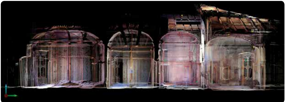
Rilievo mediante strumentazione laser-scanner
